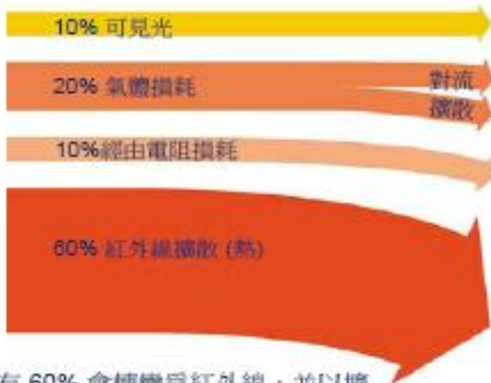
傳統鹵素燈泡所使用的能量約有 60% 會轉變為紅外線，並以擴散熱的形式損耗。
