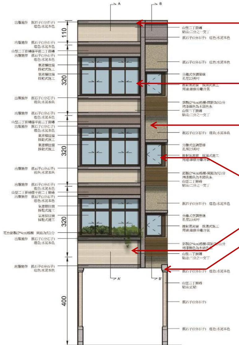
外觀設計著重於在地風貌之小面美學，於窗台設計突出線腳，使整體更富層次感，且在窗台磁磚上減少雨水接觸，外觀清潔較易維護。
