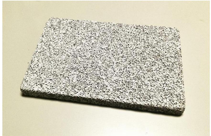
無機發泡隔熱材(可直接貼磁磚)
