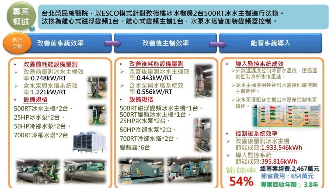
圖 3-2 醫院汰換冰水主機、周邊設備並導入變頻控制之節能效益【40】
