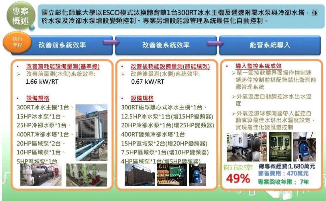
圖 3-1 學校汰換冰水主機、周邊設備並導入變頻控制之節能效益【40】
