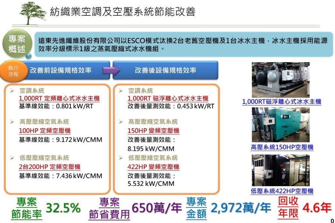
圖 3-3 採用磁浮離心式(變頻)冰水主機、變頻空壓機之節能效益【40】
