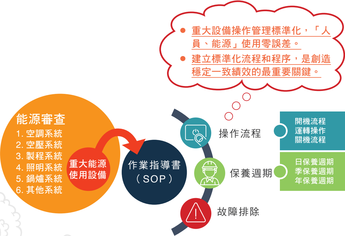
圖 3-9 重大能源使用設備操作管理重點
