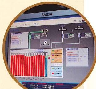
圖2 電力需量監控系統
