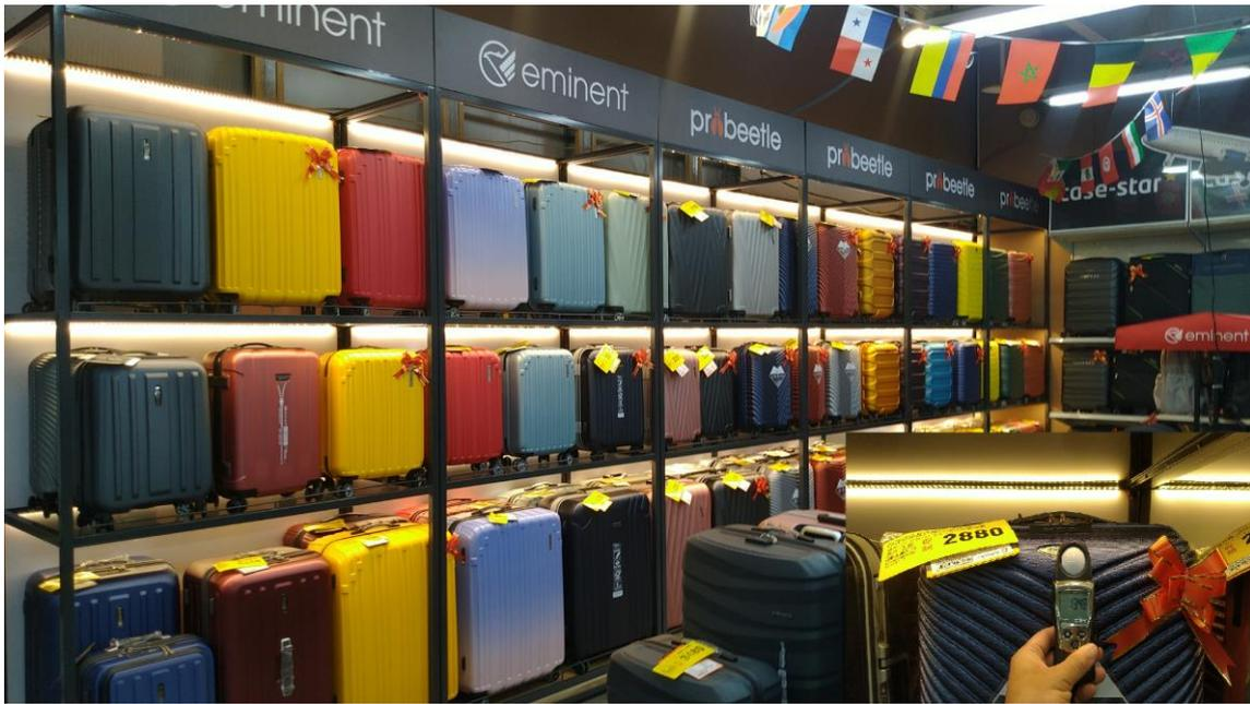
圖6-9 貨架的重點照明(暖色系、1300 Lux)
